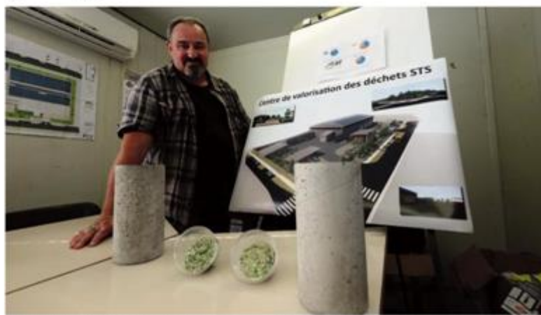
Eric Rollin, directeur technique de Sud Traitement Services, présente les essais effectués sur la poudre de verre micronisée, destinée notamment à la confection du béton (photo Julien Cinier).
